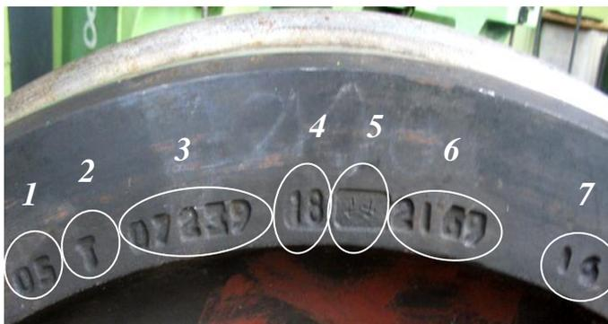
1 – две последние цифры года изготовления колеса; 2 – марка стали; 3 – номер плавки; 4 – условный номер предприятия-изготовителя колеса (номер или его торговая марка); 5 – приемочные клейма; 6 – порядковый номер колеса по системе нумерации предприятия-изготовителя; 7 – код государства-собственника колеса, наносимый на площадках в двух местах: первое клеймо - на расстоянии 100...150 мм от основной маркировки, второе – с противоположной стороны.
