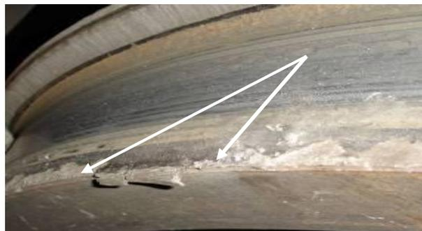
Визуальный контроль. Определение геометрических параметров откола.
