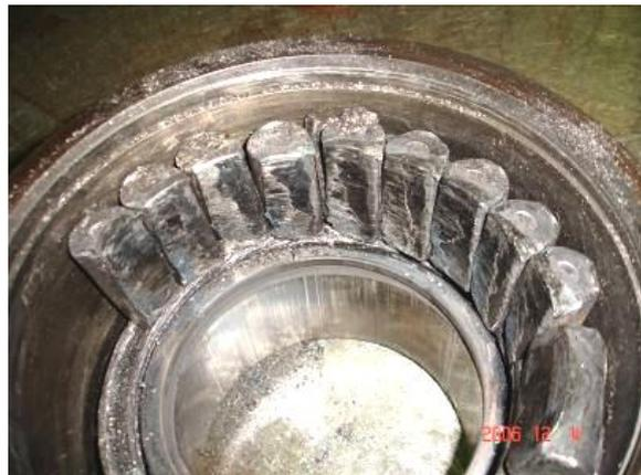
Визуальный контроль, использование наполненных средств автоматического контроля буксовых узлов в пути следования. При движении поезда искрение, выделение дыма, запах гари, движение колесной пары юзом.
